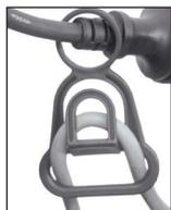
Formez une boucle avec l'extrémité du câble de rallonge et accrochez-la dans le système anti-traction du câble électrique (7).
