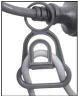
Formen Sie aus dem Ende des Verlängerungskabels eine Schlaufe und hängen Sie diese in die Zugentlastung am Netzkabel (7) ein.
