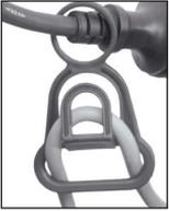
Maak van het uiteinde van de verlengkabel een lus en hang deze in de trekontlasting van de voedingskabel (7).
